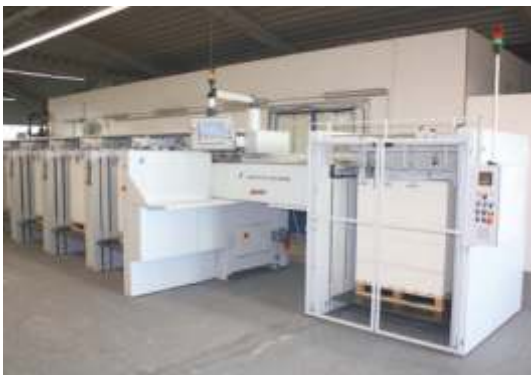
Perfekte Stapelbildung mit Hochstapelauslage.
